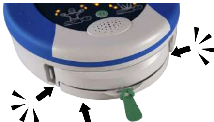
Рисунок 4. Установка картриджа Pad-Pak
