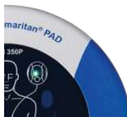
Рисунок 11. Мигание зеленого индикатора: никаких действий не требуется.
